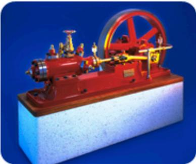
Figura 2b: Compresor de CO<sub>2</sub>, año de fabricación 1897, capacidad de 4,5TR a -10/25°C, 90rpm. Trabajó en una industria de lácteos en Dinamarca desde 1897 a 1940
