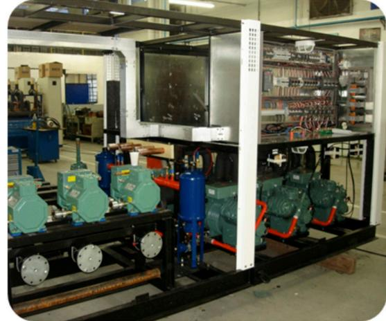
Figura 18: Detalle de montaje de los compresores de CO<sub>2</sub>
