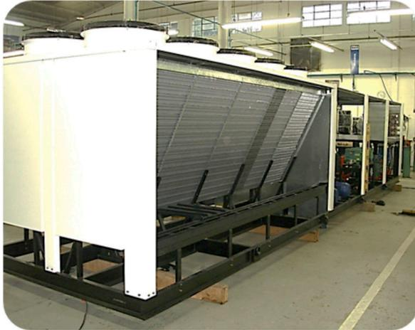
Figura 17: "Rack-house" con CO<sub>2</sub> / R134a subcrítico
